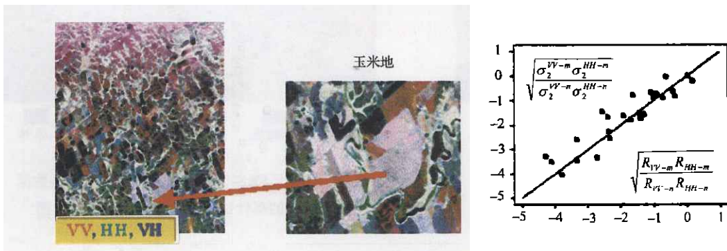
图 4 分解的双向反射分量归一化叉积和从野外测量数据计算的反射系数归一化叉积的比较
