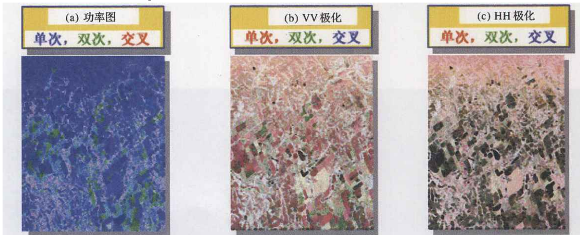
图 1 实验区的雷达图像功率图、VV 极化和 HH 极化数据目标分解后单向、双向和交叉散射分量的彩色合成图
